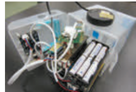
写真4 開発したポータブルCO 2 環境計測器
